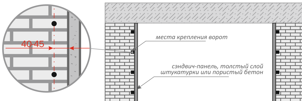
Рис. 11 Места крепления ворот к стенам (вид на левый пристенок изнутри проёма).
